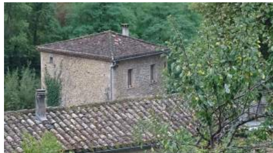
Toiture à deux pentes au premier plan et toiture à croupes au second plan.
