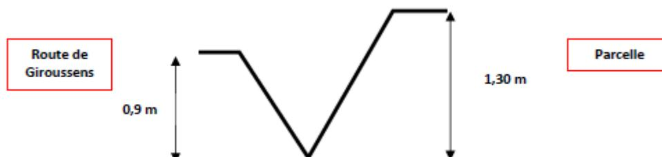
Figure 3 : Profil du fossé s'écoulant vers le ruisseau de la Saudrone : exécutoire potentiel de l'opération
