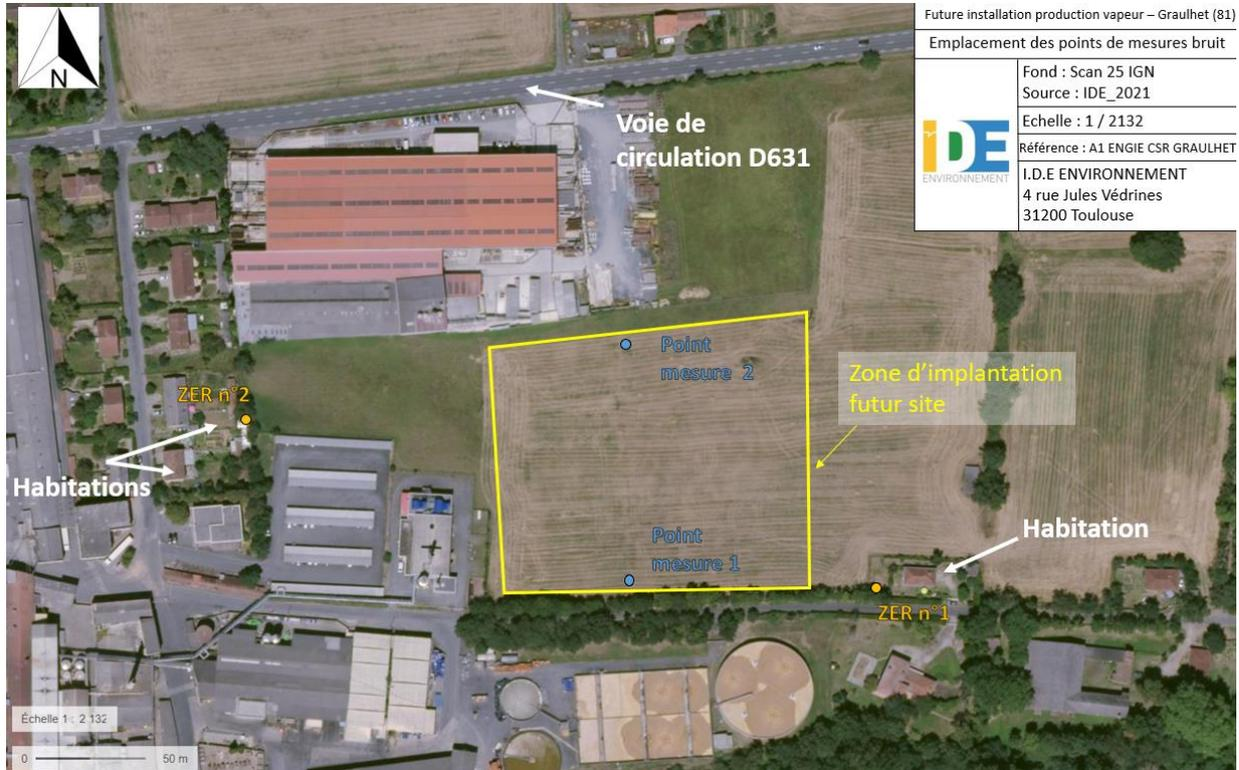
Figure 2 : Carte de localisation des points de mesure autour de la parcelle de la future installation de production de vapeur à partir de CSR de Graulhet.
