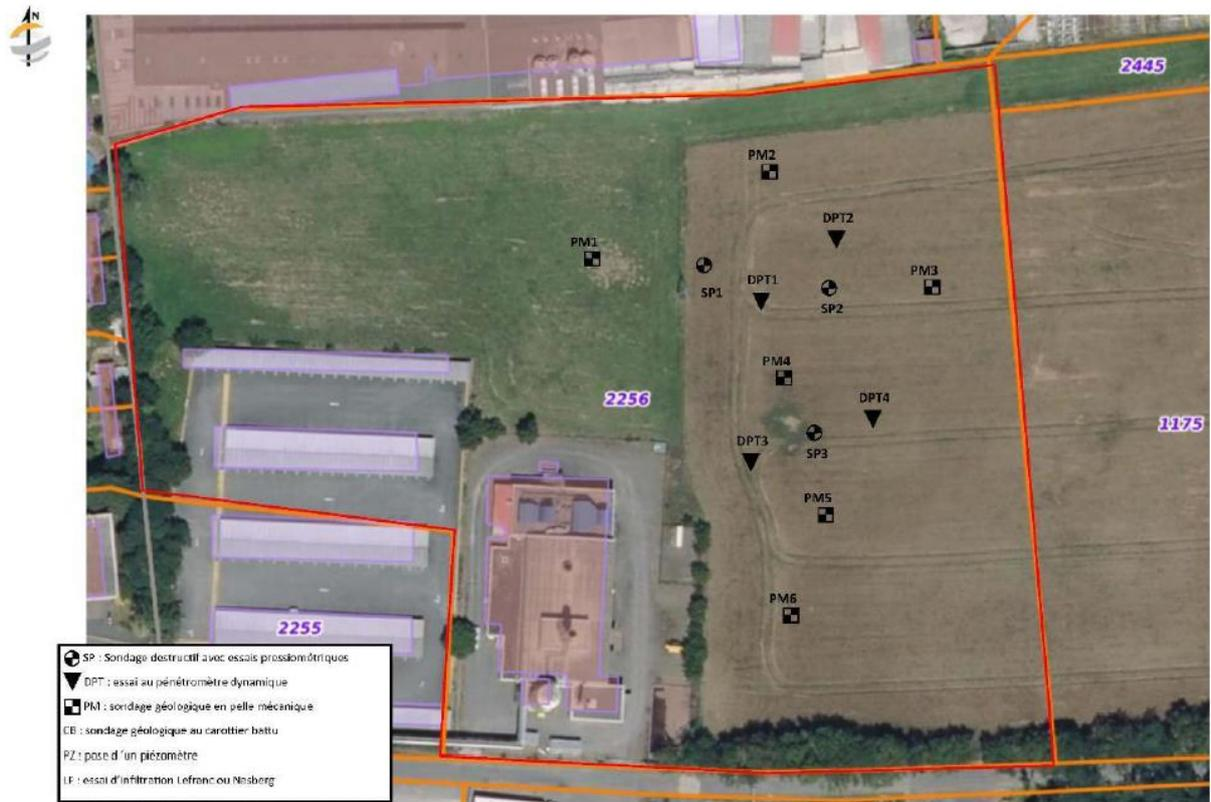
Figure 8 : Localisation des sondages et essais in situ réalisés par FONDASOL en 2022
